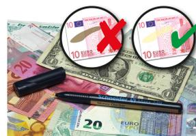
Geldschein-Prüfstift zur Echtheitsprüfung von Banknoten. Geldschein markieren: Klarer bis gelblicher Strich bedeutet "Geldschein echt", brauner bis grauer Strich bedeutet "evtl. Fälschung". Auf echten Banknoten wird die Markierung meist nach kurzer Zeit wieder weitgehend unsichtbar. Teilweise verbleibt ein heller Strich. Für alle Währungen geeignet (Ausnahmen derzeit nicht bekannt). Zur Sicherheit sollte zusätzlich ein Geldschein-Prüfgerät benutzt werden.
